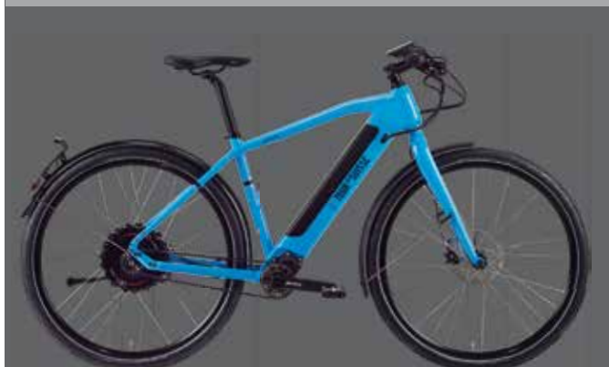
SPEEDSTER 2.0, 45KM/H mit Go Swiss Drive, Pinion und Gates Riemen
